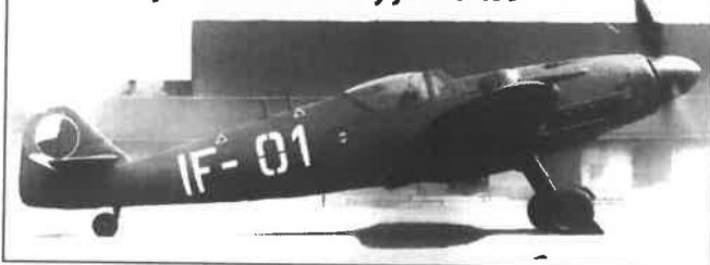
Modifikovaný stíhací letoun Messerschmitt BF-109G v našem voj. letectvu značený jako S-199
